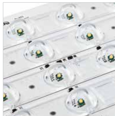
A Lensoflex® rendszer: A LED-ek sík nyomtatott áramkőri lapon helyezkednek el. Speciális lencséjükkel LED-enként járulnak hozzá a kívánt teljes fényeloszláshoz.
