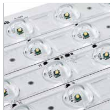
A Lensoflex® rendszer: A LED-ek sík nyomtatott áramkörü lapon helyezkednek el. Speciális lencséjükkel LED-enként járulnak hozzá a kívánt teljes fényeloszláshoz.
