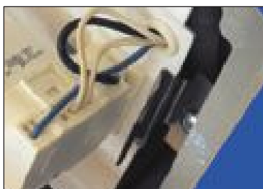
A szerelvénylap – melynek egyik oldalán a fényforrás, másik oldalán a szerelvények helyezkednek el – laprugó ellenében lehajtható.
